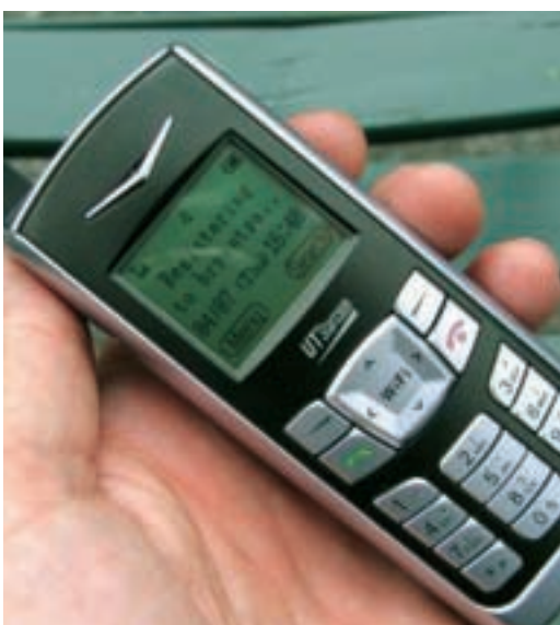
Das UTStarcom F1000 ist ein SIP-Telefon im Handy-Format und lässt sich in WLAN-Umgebungen unkompliziert nutzen – einbuchen und lostelefonieren. Das F1000 ist zudem eine elegante Alternative zur schnurgebundenen Kombination aus Festnetz-Telefon und VoIP-Adapter.
