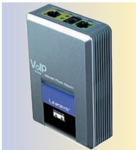
Der SPA 1001 von Linksys ist ein Adapter, mit dem man seinen VoIP Account sowie ein angeschlossenes Endgerät verwalten kann.
