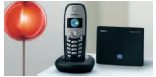
Siemens zeigte mit dem Gigaset C450 an der diesjährigen CeBIT erstmals ein DECT-Telefon mit VoIP-Funktionalitäten. Das Hybridmodell hat an der Basisstation sowohl einen Festnetz wie einen LAN-Anschluss. Damit lassen sich die VoIP-Funktionen ohne einen PC realisieren.
