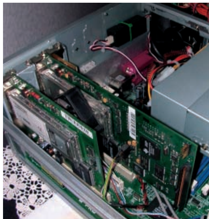
DVB-S Karte macht PC zum TV – zusammen mit einer Satellitenschüssel
