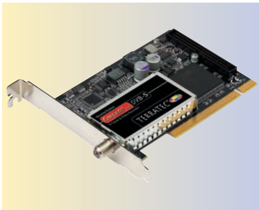
Das DVB-S PC-Board entschlüsselt die digitalen Satelliten-Signale zu Fernsehprogrammen
